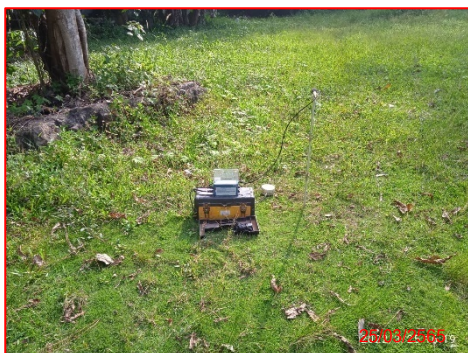
การตรวจวัดแรงสั่นสะเทือนจากการใช้วัตุระเบิด
